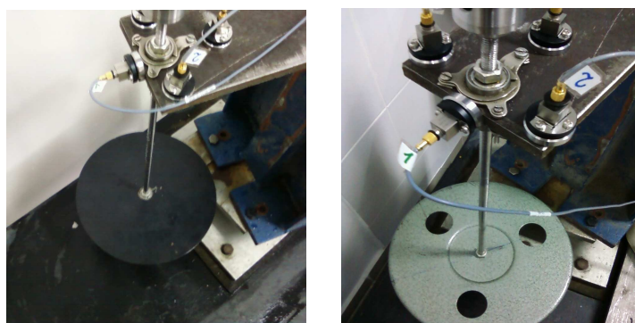
Fig. 7.6 Amplasarea celor patru accelerometre pe instalatia experimentală
