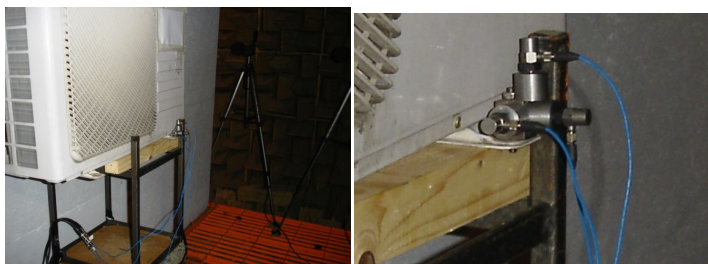
Fig. 6.7 – Imagini ale lanțului de măsură efectuate înainte de măsurători cu cele 3 puncte pentru vibrații
