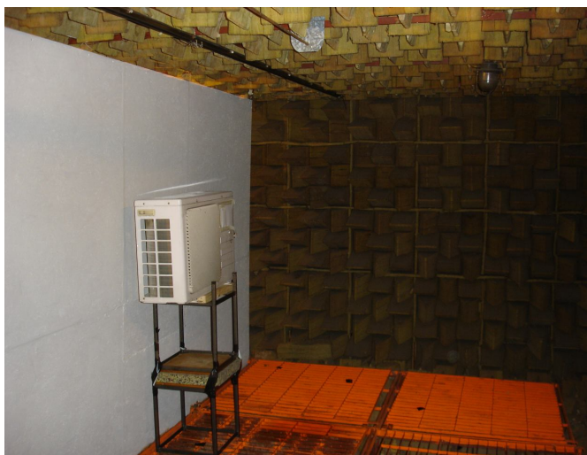
Fig. 6.1 – Standul amenajat în camera anecoică pentru realizarea măsurătorilor
