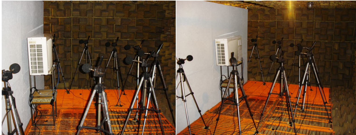
Fig. 6.6 – Imagini ale lanțului de măsură înainte de înregistrări cu cele 8 puncte pentru zgomot
