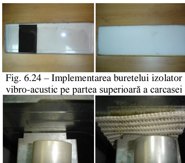
Fig. 6.26 – Izolarea unor elemente active de structura de bază a instalației
