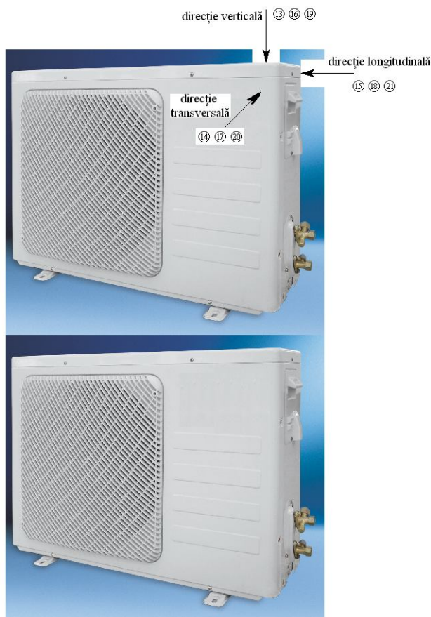
Fig. 5.7 – Locația nr.2. Amplasarea punctelor de măsură pentru înregistrarea vibrațiilor pe cele 2 unități exterioare
