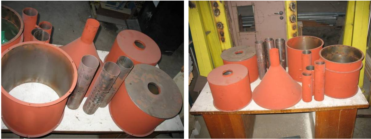
Fig. 5.1. Elementele demontabile ale atenuatorului
