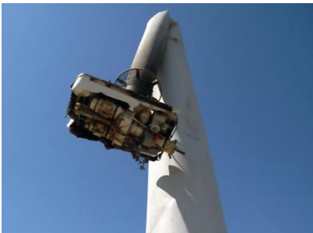
Fig. 3.8 – Depășirea limitei la încovoiere a turnului unei turbine eoliene din districtul Lincoln (USA), în condiții de furtună 24
