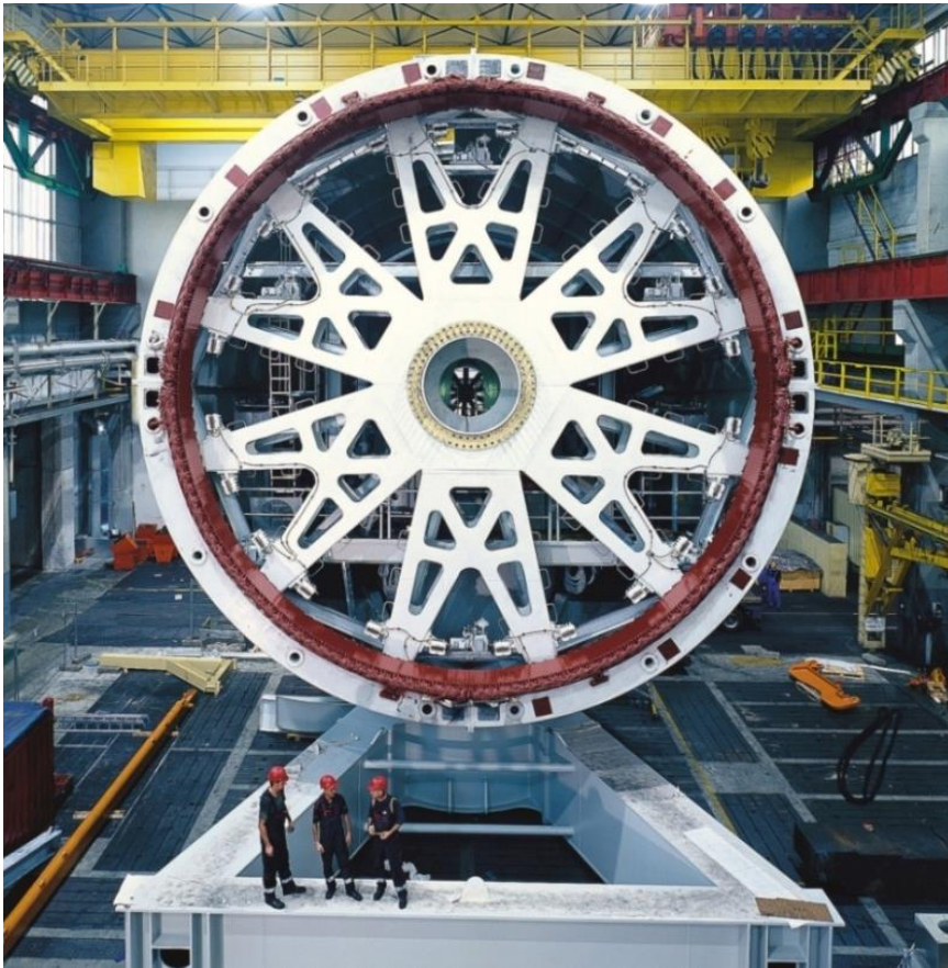
Fig. 3.8 – Generator cu antrenare directă de la arborele rotorului; dimensiunea este de 10 ori mai mare decât a unui generator antrenat prin intermediul transmisiei [47]
