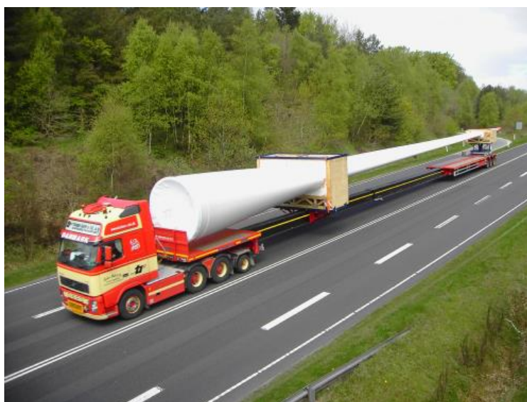
Fig. 3.5 – Paleta de 62 m, pentru o turbină cu ax orizontal 23
