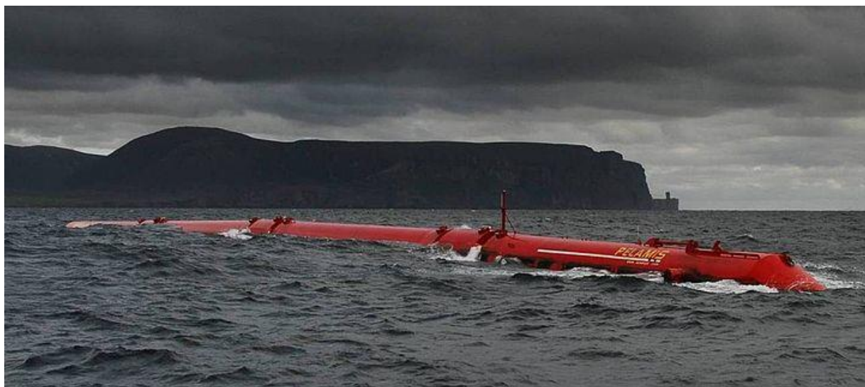
Fig. 5.4 – Sistem Pelamis în funcțiune, cu 3 segmente articulate 45
