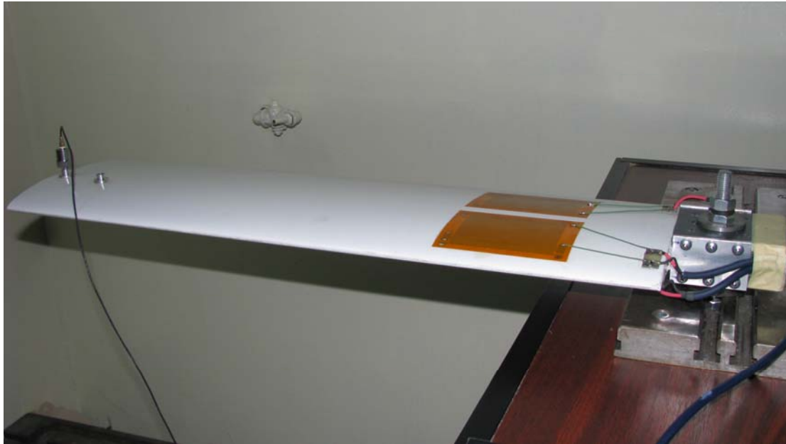
Fig. 6.1. Modelul de aripă încastrată pe banc cu cele două perechi de elemente de acționare în apropierea încastrării și accelerometrul montat pe vârful liber al aripii
