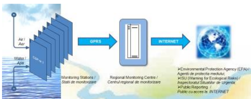
Fig. 1 – Information infrastructure of the real-time monitoring network and warning in case of ecological risk / Infrastructura informatica a rețelei de monitorizare in timp-real și de avertizare in caz de risc ecologic
