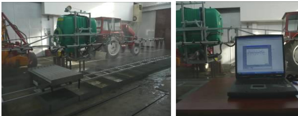
Fig. 3 – Aspects during transversal distribution uniformity determination / Aspecte din timpul determinării uniformității distribuției transversale
