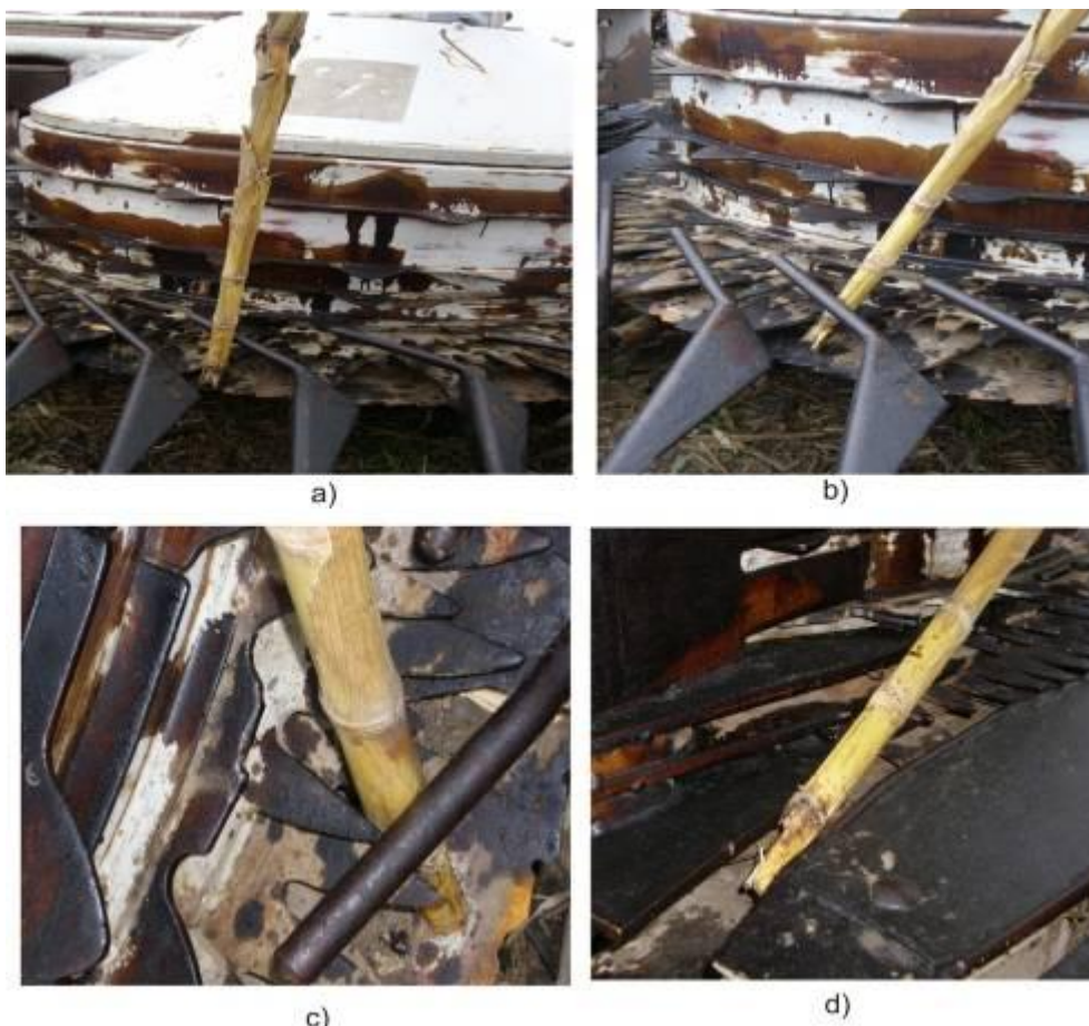
Fig. 2. Stages of engaging and evacuation of stalks with the rotary working bodies / Etapele de antrenare și evacuare a tulpinilor cu organele de lucru rotative
