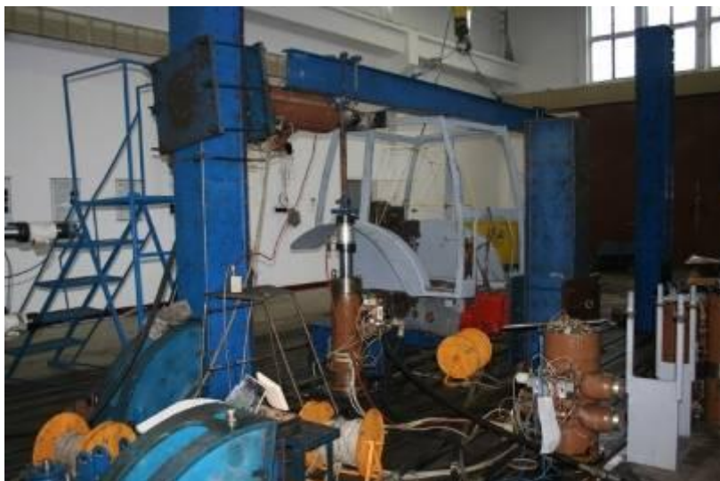
Fig. 4 - Assembling realised on the "Hidropuls" plant for testing the cab of the Universal tractor in the case of front crushing / Montajul realizat pe instalația "HIDROPULS" pentru încercarea cabinei tractorului universal, în cazul strivirii față
