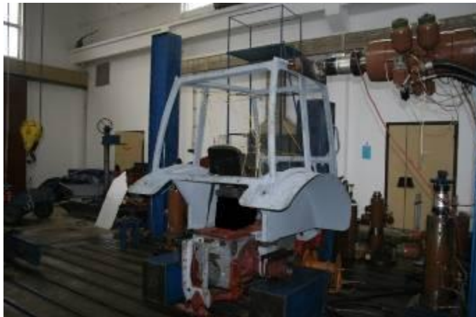
Fig. 3 - Assembling realised on the "Hidropuls" plant for testing the cab of the Universal tractor in the case of lateral loading application / Montajul realizat pe instalația "HIDROPULS" pentru încercarea cabinei tractorului Universal, în cazul aplicării sarcinii laterale
