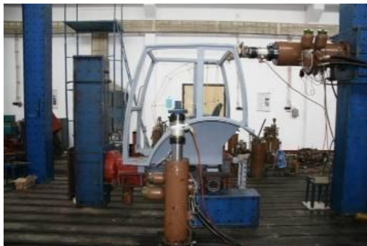
Fig. 1 - Assembling realised on the "Hidropuls" plant for testing the tractor cab, in case of application the longitudinal loading from behind / Montajul realizat pe instalația "HIDROPULS" pentru încercarea cabinei tractorului, în cazul aplicării sarcinii longitudinale din spate
