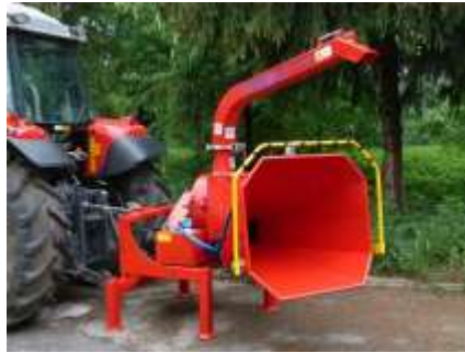
Fig. 14 - Shredder SKORPION 120R /160 R / 250 R [8]
