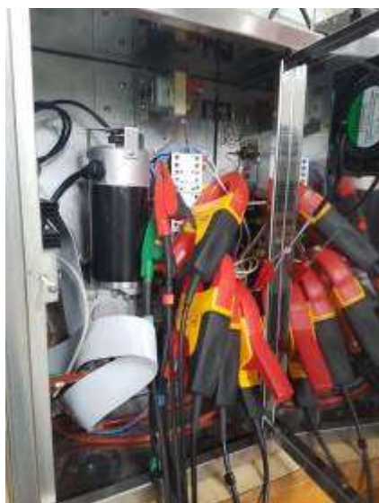
a) b) Fig. 3 - a) clamping the pliers; b) Fluke 434 clamp meter phase
